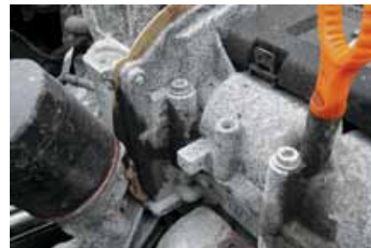
Двигатель потеет маслом через прокладку передней крышки
