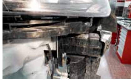
Так выглядит целый сминаемый элемент (на неповрежденной правой стороне). К лонжерону он крепится при помощи болтов
