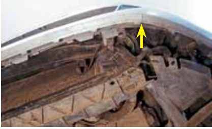
Облицовка бампера помялась и треснула снизу (показано стрелкой), пострадала пластиковая передняя панель, но радиатор остался цел
