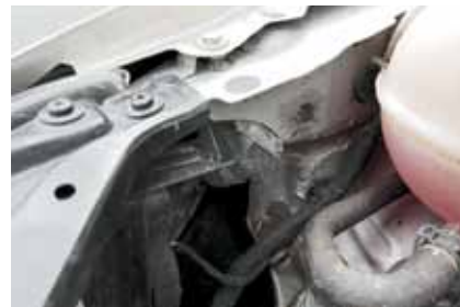
В полостях передних крыльев обнаружилась забавная шумоизоляция — полиэтиленовые пакеты с поролоном
