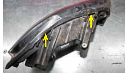
У левой, попавшей под удар фары сломались только защелки крепления. Обидно, что отдельно от фары они не меняются
