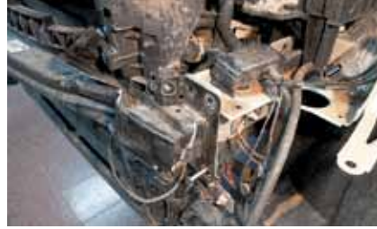
Основной удар приняли поперечный брус и единый с ним сминаемый элемент перед лонжероном, но сам лонжерон не пострадал
