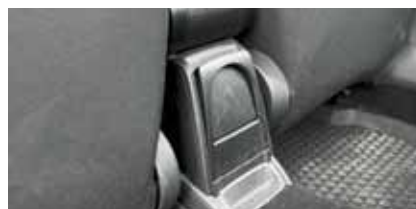
Задний подстаканник слабо фиксируется и болтается в сложенном положении
