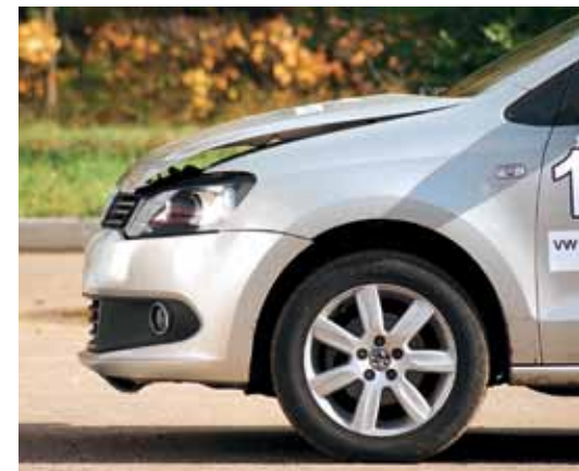
После удара Polo остался на ходу. Ничего не пошло, обе фары работали, а сгорбленный капот открылся
