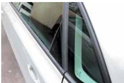
У обеих задних дверей отходят пластиковые треугольнички накладок
