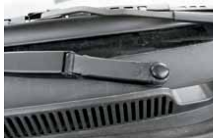
Десятки часов пребывания в коррозионной камере обезобразили поводки стеклоочистителей...
