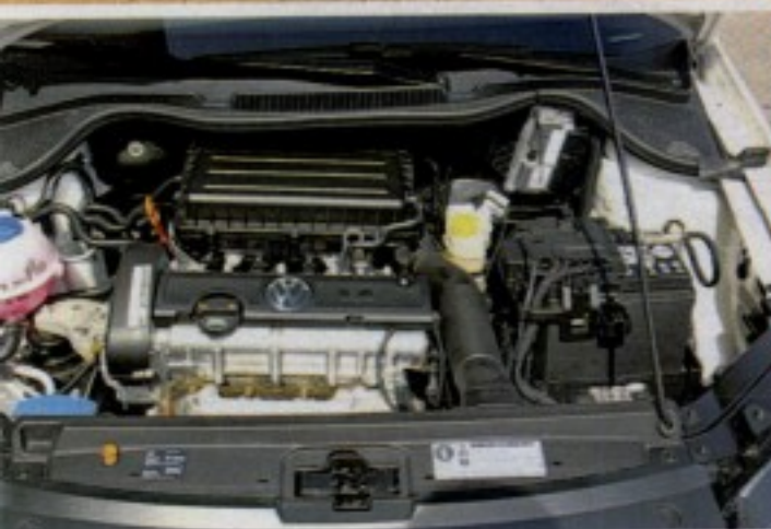
☛ Подкапотное пространство новой модели с 86-сильным двигателем 1,4 MPI. Задача из серии «найди десять отличий от модели прошлого поколения».
